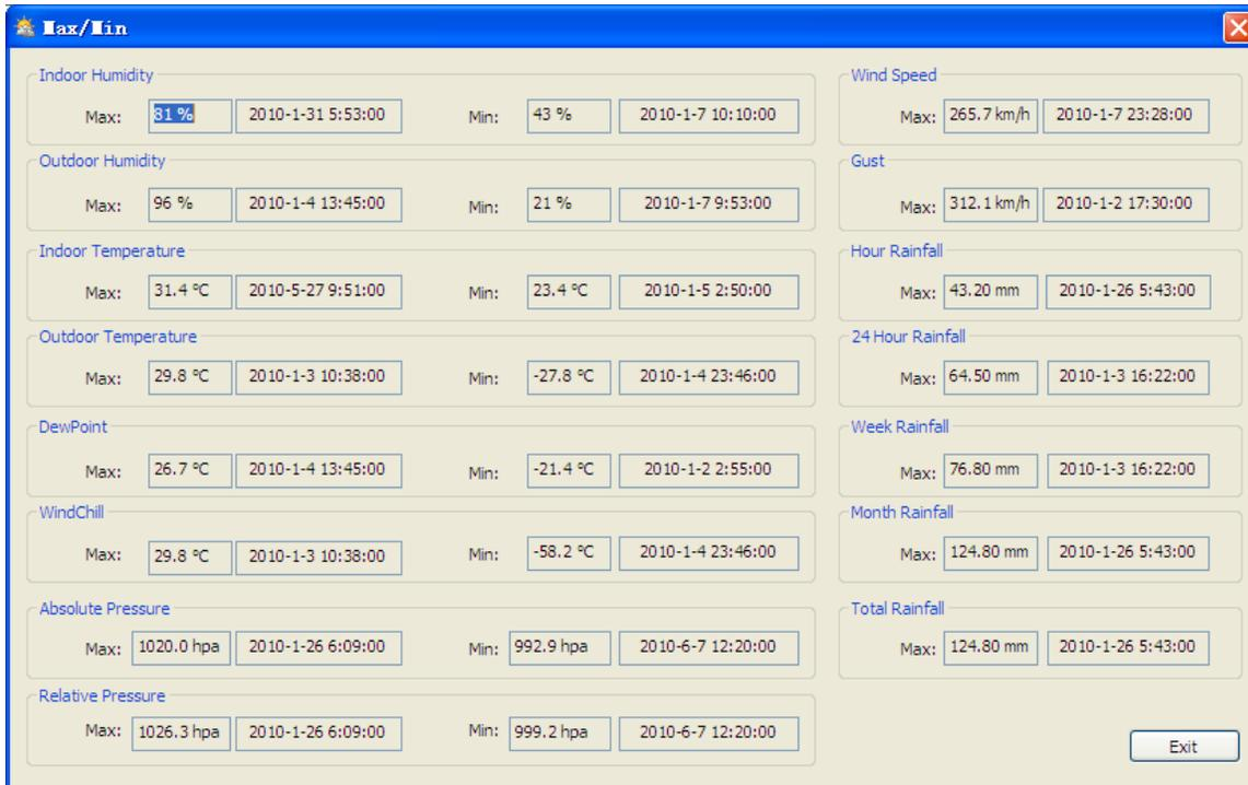
Esta sección se utiliza para mostrar el min registrado y el valor max grabado con marca de tiempo. reinicio Min / Max sólo se puede hacer a través de operación de tecla de la estación base.
